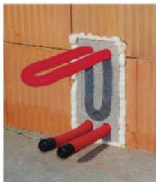
PEBE 2-280 CU-G wie PEB 2-280 CU, jedoch der oben geschlossene Rohrbogen ermöglicht das Abdrücken und die Inbetriebnahme der Heizkreise ohne Heizkörper. Schutzrohr und Putzkappen schützen vor Mörtel.
